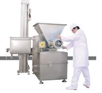
DKM Ø 200 kıyma makinesi çift devir motoruyla donuk et ve taze et çekiminde kullanıcılara kolaylık sağlar. Birinci devir, donuk et çekimi için, ikinci devir taze et çekimi için kullanılmaktadır. Kafa grubunda bulunan helezon yataklama bileziği ile helezon sürtünmesi minimuma indirilmiştir. DKM Ø 200'lük kıyma makinasında asansör mevcuttur. Makina ile birlikte Ø 200 lt standart et taşıma arabası verilmektedir.
